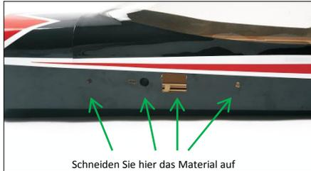
1.) Schmelzen Sie mit einem LötKolben die vorgestanzten Löcher frei.
