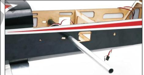
46.) Stecken Sie die Aluminiumstange für die Befestigung der Tragflächen in den Rumpf (D4)
