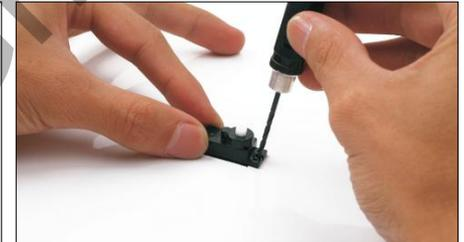
30.) Bohren Sie mit einem 1.5mm Schraubendreher die Löcher zur Servobefestigung vor. Geben Sie eine kleine Menge Weißleim hinein und befestigen Sie das Servo mit den Schrauben.
