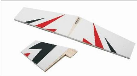
11.) Die Abbildung zeigt die fertig vorbereiteten Leitwerke.
