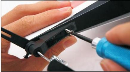
9.) Bohren Sie die Löcher zur Spornradbefestigung mit 2mm vor. Die Drehachse des Spornrahtes muss genau zwischen Leitwerk und Seitenruder sein.
