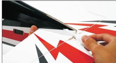
18.) Stecken Sie das Höhenleitwerk an das Heck des Flugzeuges und justieren Sie es parallel zum Rumpf und zur Tragfläche. Nach der korrekten Justierung befestigen Sie die Finne mit Sekundenkleber oder Epoxy..
