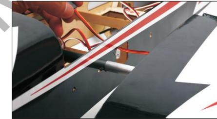
47.) Stecken Sie die Tragflächen auf, und führen Sie die Servokabel durch den Rumpf.
