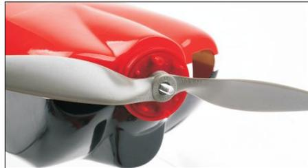
43.) Montieren Sie die Spinnerhalteplatte und die Luftschraube.
