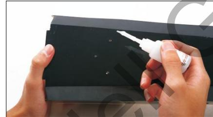
5.) Stoßen Sie die vorgestanzten Löcher für den Fahrwerksbügel durch. Bohren Sie die Löcher mit 2mm vor. Füllen Sie vor dem Verschrauben z.B. Weißleim in die Löcher.
