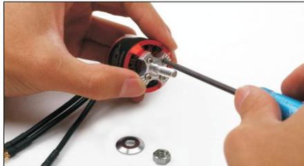
35.) Schrauben Sie die Luftschraubenaufnahme an den Motor. (Sicherungslack verwenden!)
