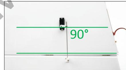
31.) Nun montieren Sie das Servohorn und das Gestänge.
