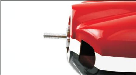
41.) Montieren Sie die Motorhaube, und stellen Sie sicher, dass der Propellerantrieb 3cm vorne herausragt.
