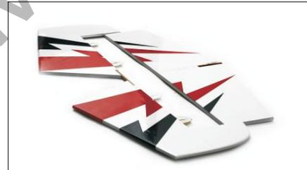
15.) Verkleben Sie nun Leitwerke und Ruder mit dem beiliegenden Fliesscharnier
